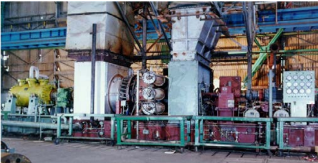
विजयपुर के लिए गैस टर्बाइन चालित लाइट एंड फ्रैक्शंस कंप्रेसर का स्ट्रिंग परीक्षण
