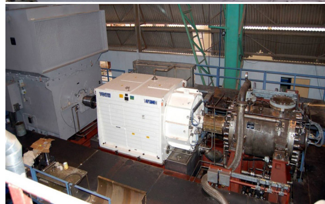
मार्मुल, ओमान के लिए जॉब मोटर द्वारा संचालित प्राकृतिक गैस कंप्रेसर का स्ट्रिंग परीक्षण
