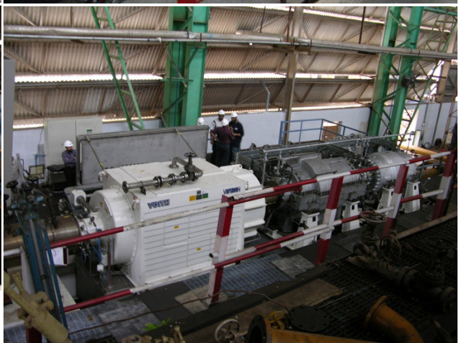
लेखवायर, ओमान के लिए मोटर द्वारा संचालित गैस लिफ्ट कंप्रेसर ट्रेन का स्ट्रिंग परीक्षण
