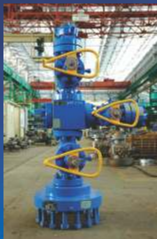
बीएचईएल के तिरुचिरापल्ली, तमिलनाडु इकाई में निर्मित एक्स-मस ट्री वाल्व
