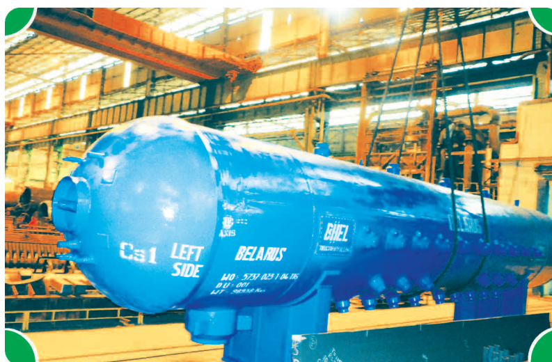
HRSG Drum supplied by BHEL for Grodno Power Project, Belarus
